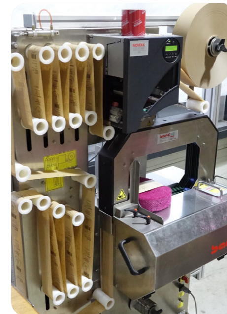
A máquina Bandall com o sistema de tampão do lado esquerdo assegura a continuidade do processo de cintagem.
